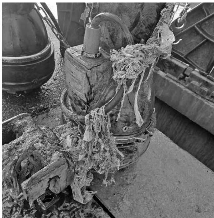
Následek – ucpané čerpadlo, foto F. Petrásek
